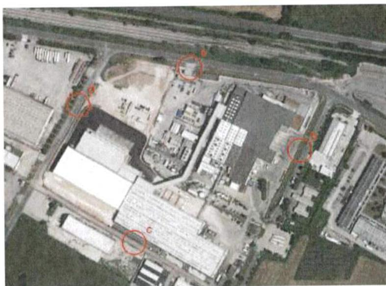
Figura 5: dettaglio stazioni di monitoraggio del rumore
